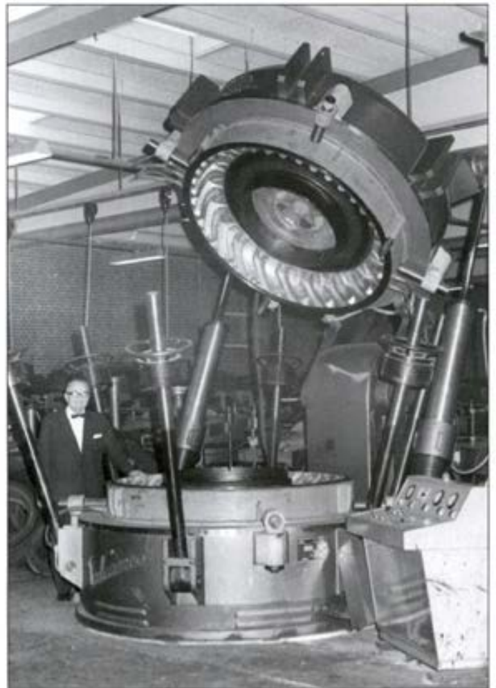
Ejvind Mortensen, Viborg Slidbanefabrik, ved en vulkaniserings-presse til entreprenordæk.
