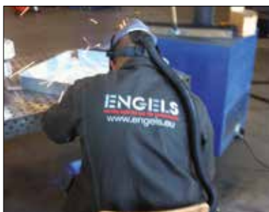
Soldadura de alumínio. Muitos dos nossos produtos são feitos à base de alumínio devido ao baixo peso e à boa resistência à corrosão.
