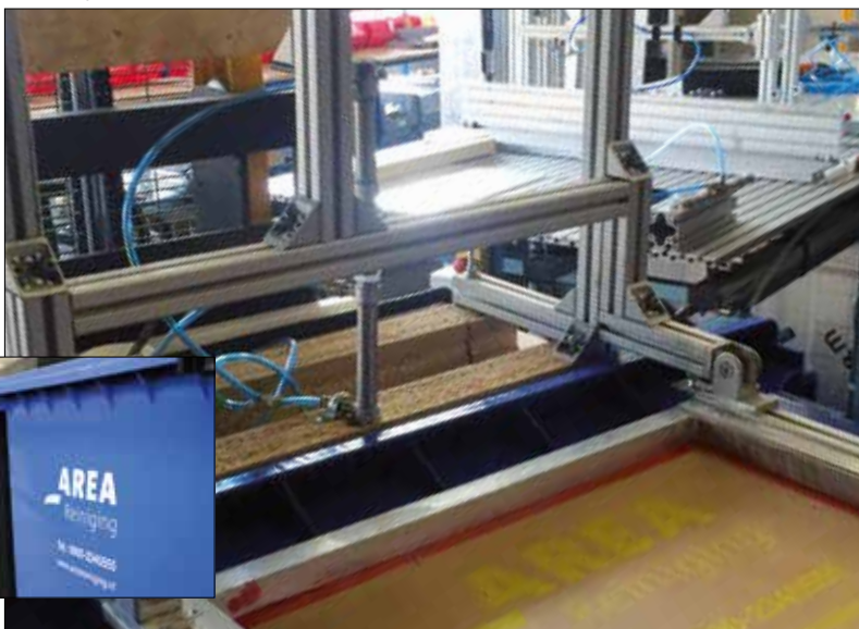
Impressão por serigrafia semi-mecânica, aqui em contentores com 4 rodas. O contentor é deslizado sob a tela, mecanicamente polido, a tela é rebaixada automaticamente e a tinta é aplicada manualmente.
