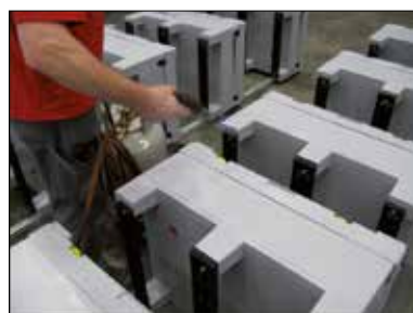
Os contentores são aquecidos para que a tinta adira firmemente.
