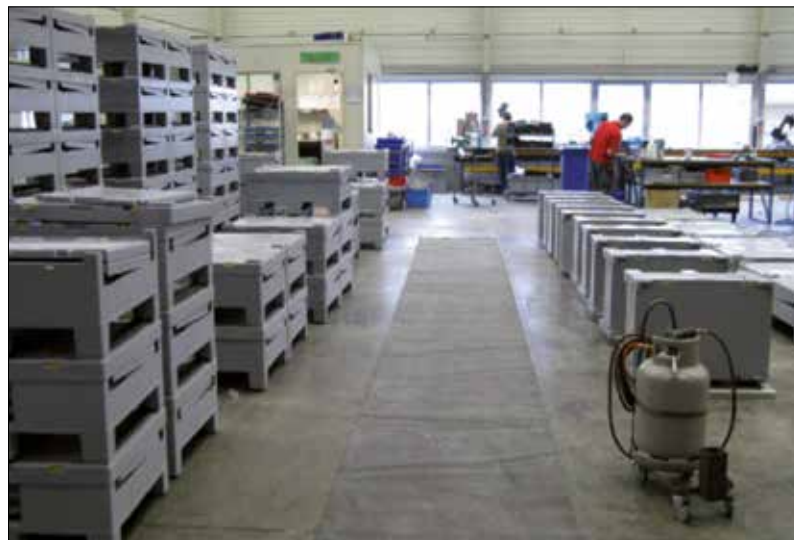
Visto que os contentores têm de ser impressos de ambos os lados, são colocados num trilho onde ficam a secar.
