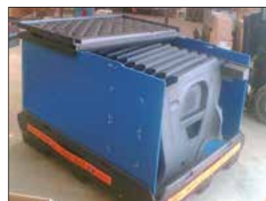
Paletes com laterais superiores de placas caneladas e tampas em conjunto com um interior de espuma para manter as peças automóveis no devido lugar.
