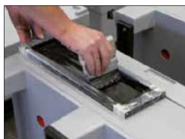
A tela é premida sobre o contentor e a tinta é aplicada com um movimento de pressão.
