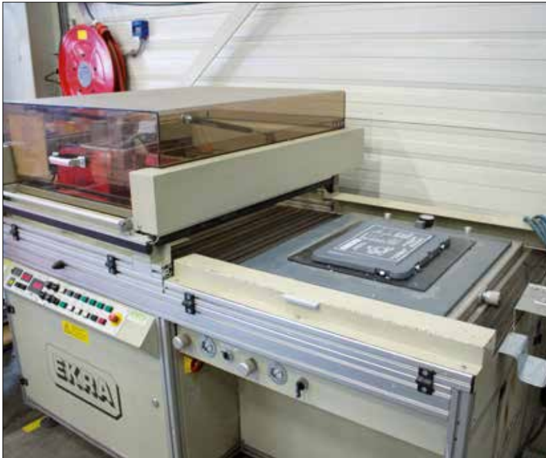
Serigrafia mecânica de tampas. A tampa é mecanicamente aplicada sob a tela de serigrafia e a tinta é automaticamente impressa.
