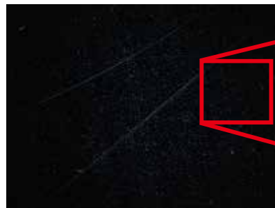
Campo oscuro: Permite la observación destacada de anomalías microscópicas como defectos y contaminación mediante el uso de luz difusa
