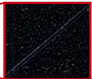
Interferencia diferencial: permite la observación de asperezas microscópicas difíciles de detectar con observación ordinaria de campo claro
