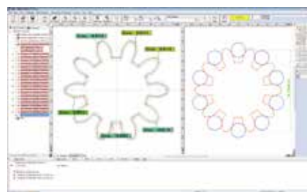
Ejemplo de coincidencia de contornos de engranes y análisis de diámetro sobre pernos
