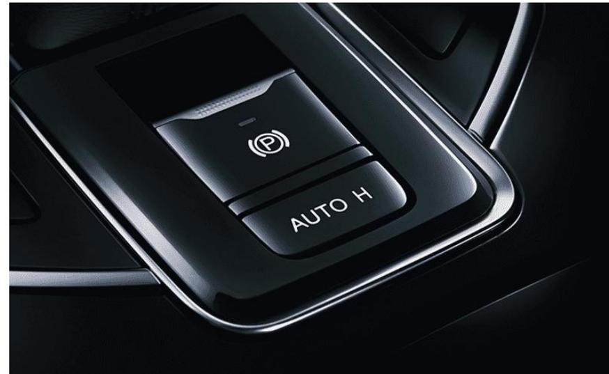
Con el **Sistema AutoHold** se mantiene el vehículo detenido en pendientes, sin necesidad de mantener el pie en el freno. Esto proporciona comodidad y reduce la fatiga del conductor, especialmente con tráfico intenso o en terrenos con desniveles.
