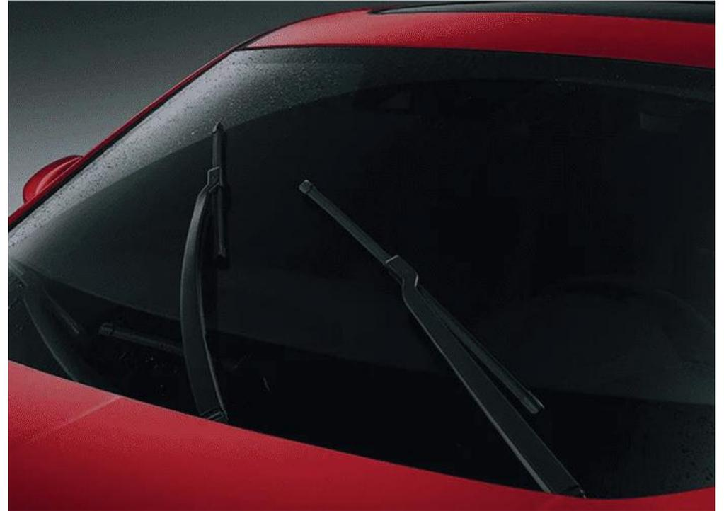
La sofisticada tecnología de **sensor de lluvia** detecta sutiles cambios climáticos, activando automáticamente los limpiaparabrisas para brindarte una conducción siempre clara y segura.
