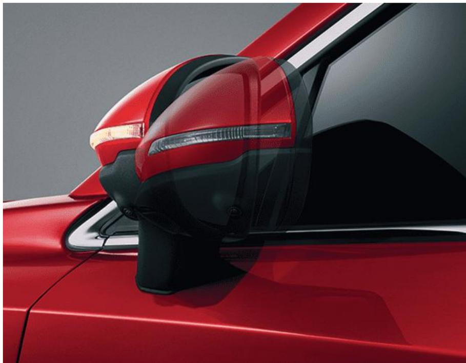
Los **retrovisores calefactables y eléctricamente** ajustables ofrecen la máxima comodidad al conductor, permitiendo una personalización rápida y precisa para una conducción más segura y placentera.
