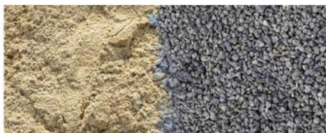
Agregados: Areia lavada e brita de várias granulometrias
