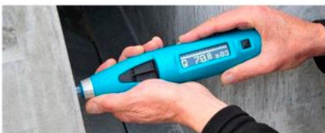
Classe de Resistência do Betão: C35 - determinada por teste com esclerómetro (martelo de Schmidt)
