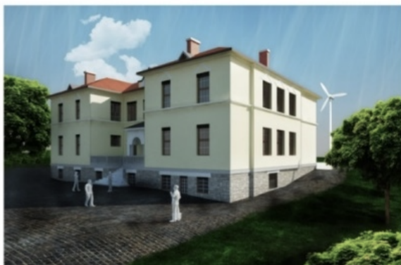
Fotografija 8.36. Automatizirani dijelovi ovojnice (vanjski otvori) zgrade JU OŠ Saburina u Sarajevu (a) fasadna struktura je osunčana, zaštita i proizvodnja el. energije aktivirani (b) fasadna struktura nije osunčana, zaštita i proizvodnja el. energije deaktivirani
