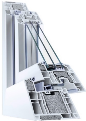
Fotografija 5.12. Vanjski otvor Salamander BluEvolution , The bluEvolution 92 sustav profila ujedinjuje vrhunsku tehnologiju usmjerenu na budućnost s modernim, pragmatičnim dizajnom za novu generaciju prozora svjetske klase. Optimizirani 6-komorni profil s ugradbenom dubinom od 92 mm pruža vrhunsku toplinsku izolaciju i izvrsnu energetska učinkovitost. U kombinaciji s filigranskom vidljivom širinom od samo 118 mm, solarnim dobicima zahvaljujući velikom upadu svjetlosti i ekološkoj održivosti PVC-a koji se može 100% reciklirati, ovo je jedan od Salamanderovih sustava budućnosti. U-vrijednost 0,71 \text{ W/m}^2\text{K}
