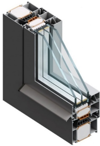
Fotografija 5.10. Vanjski otvor Feal 85Plus , Vanjski okvir je aluminij, moguća obrada u različitim bojama kao i u teksturi koja imitira drvo. U kombinaciji sa staklom od 3 sloja je moguće u zavisnosti od odnosa površine profila i stakla dostići U-vrijednost 0,8 \text{ W/m}^2\text{K} ili nešto nižu.
