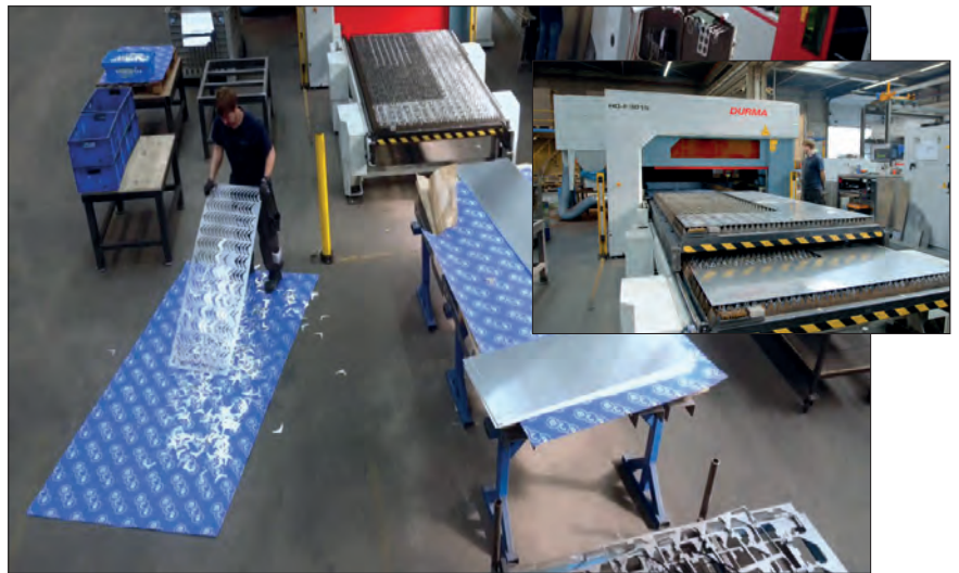
Onderdelen worden met de laser gesneden. Snel en modern.
