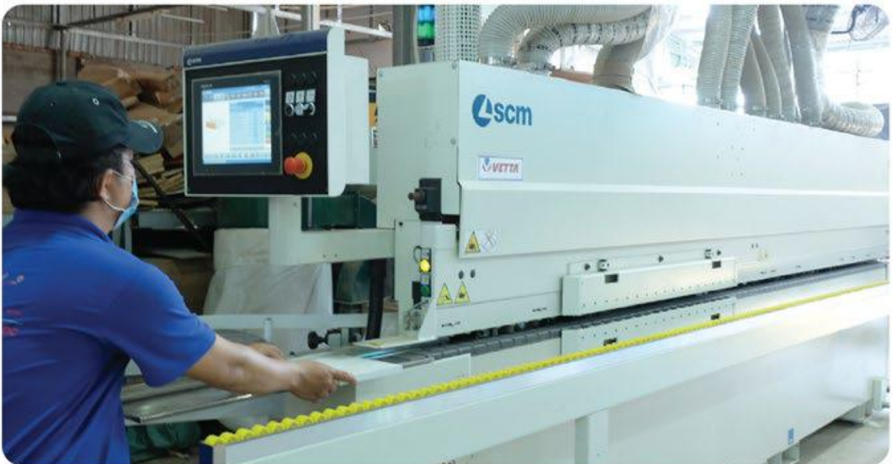
* Hệ thống máy dán cạnh tự động đa chức năng SCM - xưởng Mộc. SCM multi-function automatic edge banding machine system - Wood workshop.
