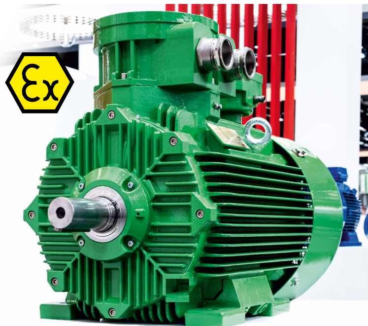
Silnik ognioszczelny w klasie sprawności IE4 (Ex db eb, IIC) z chłodzeniem obcym, do zasilania z przemiennika częstotliwości
