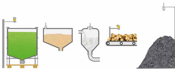
▲ Sondy radarowe VEGAPULS serii BASIC niezawodnie mierzą poziom cieczy i materiałów sypkich w różnego rodzaju aplikacjach.
