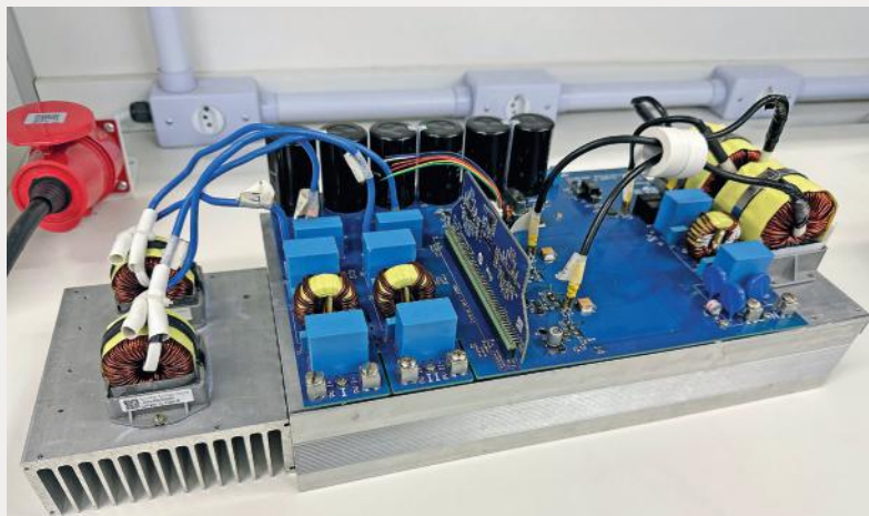
Modelo desenvolvido do tipo string é o mais adotado nos sistemas fotovoltaicos de médio porte, porém a maior parte dos equipamentos usados no país são importados
