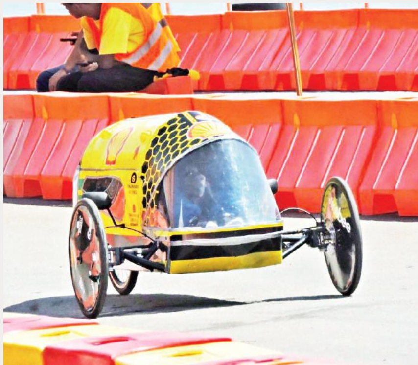
Alunos do IFC de Luzerna desenvolvem desde a fabricação dos chassis e laminação da carenagem até os sistemas de armazenamento de energia, de tração e de telemetria
