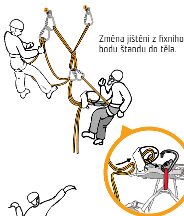
Odlez prvolezce, jistění prvolezce do těla.
