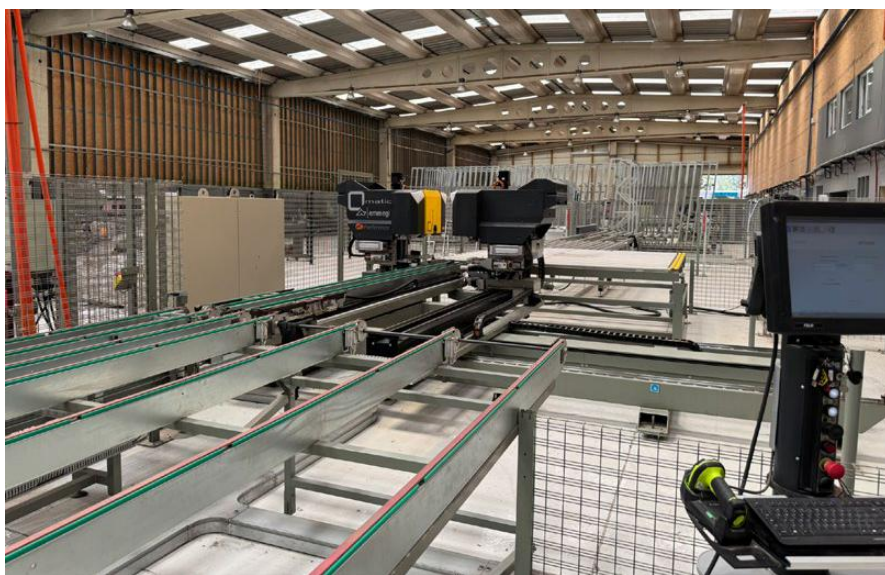
La implementación exigió instalar físicamente la línea EMMEGI INTEGRA Q2 y realizar una compleja integración del software PREFSUITE .
