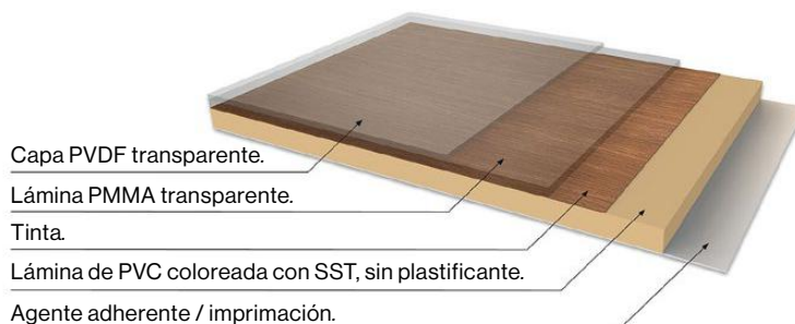
Estructura esquemática de la lámina de exteriores RENOLIT EXOFOL PFX .
