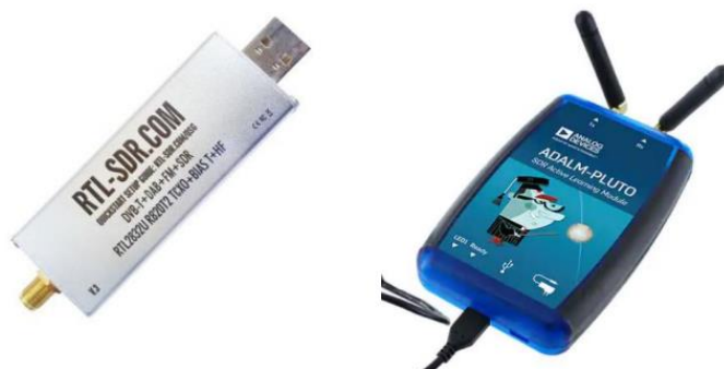
Fig. 1: Izquierda: módulo SDR RTL2832U. Derecha: ADALM PLUTO.
