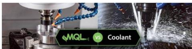
Fig. 1: Aplicación de MQL y de sistema inundado en operaciones de mecanizado por arranque de viruta: Fresado. [4]
