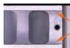
Medición del borde de una pieza escalonada (modo de alta resolución)
