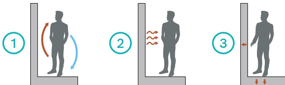
**El calefactor HC 4000** transfiere el calor principalmente por convección hacia el aire y una parte es transmitida por radiación hacia los cuerpos.
