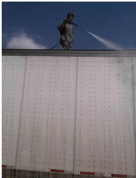
Fig. 1.1 Aplicación de la prueba de agua en una caja seca
