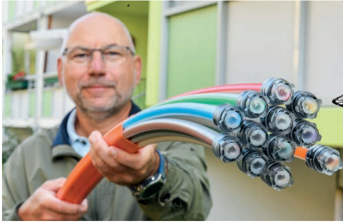
Jedes Glasfaserkabel hat 12 Adern
