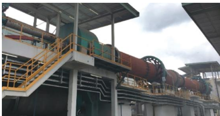
Fig. 2: Horno rotatorio utilizado para calcinar arcilla
