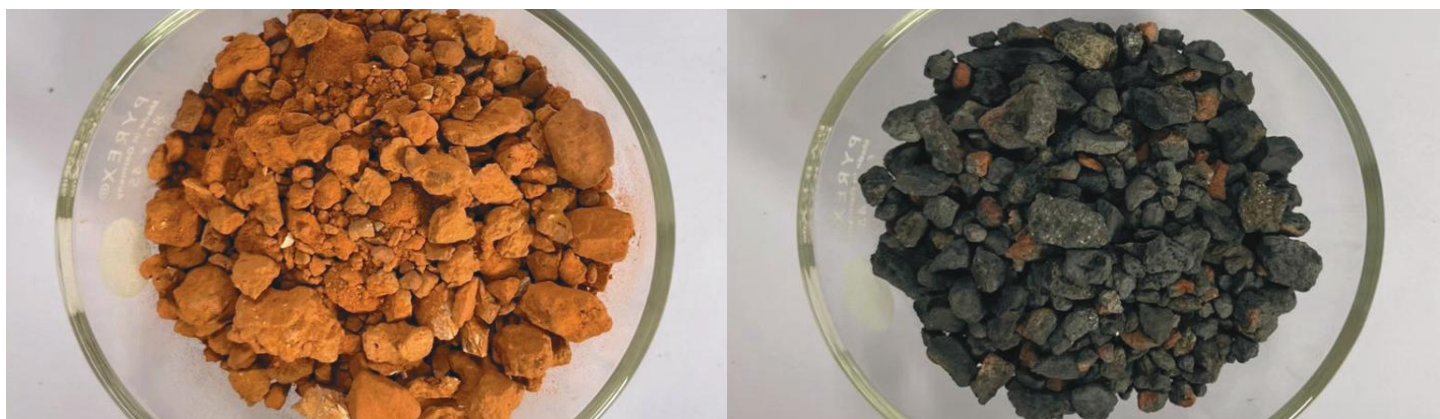
Fig. 3: La arcilla calcinada después de salir del horno es tanto de color rojizo (izquierda) como gris (derecha)
