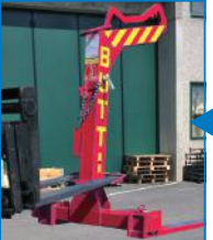
Le forche Grucar sono dotate di un supporto per la movimentazione e lo stoccaggio della sola forca (senza carico)
