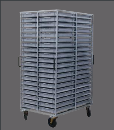
Regale mit Behältern für Mehlwürmer
