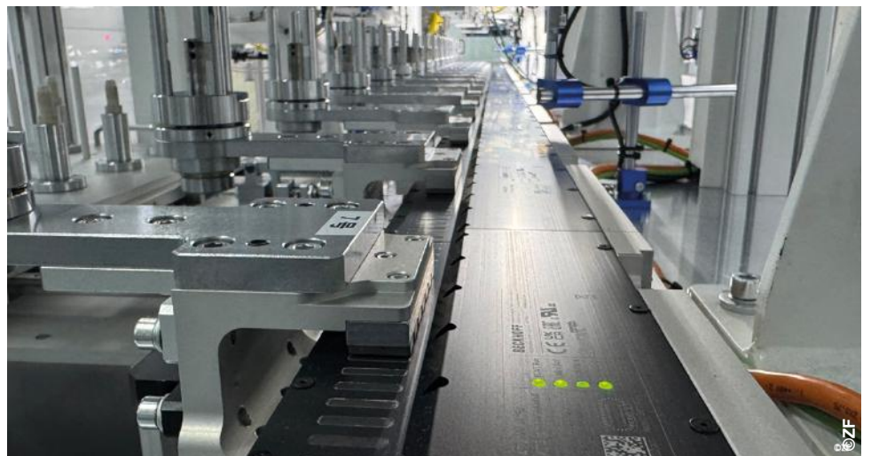
El sistema de transporte inteligente XTS de Beckhoff ha hecho una contribución significativa al aumento de la eficiencia de producción en ZF en China
