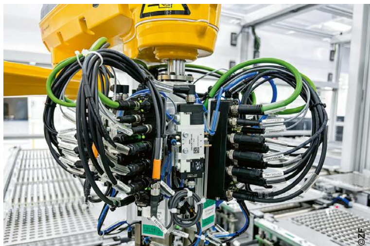
La amplia gama de EtherCAT I/Os de Beckhoff también incluye módulos IP67 Box que pueden montarse directamente en sitio.
