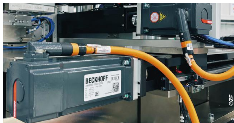
Los servomotores AM8000 de Beckhoff con la tecnología One Cable Technology (OCT) también aseguran movimientos altamente dinámicos
