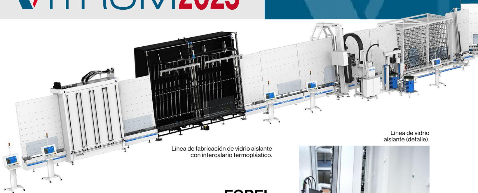
Línea de fabricación de vidrio aislante con intercalario termoplástico.
