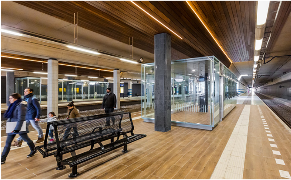
Station Rijswijk Een bekleding van hout op plafond en perron markeert de wachtruimte, waar geluid en wind even buitengesloten kunnen worden.
