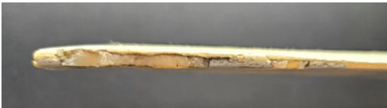
Figura 5. Álabes con erosión de 1 milímetro de profundidad.
