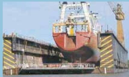
Tiene un dique flotante para Reparaciones con una capacidad de Izaje de 6000tn
