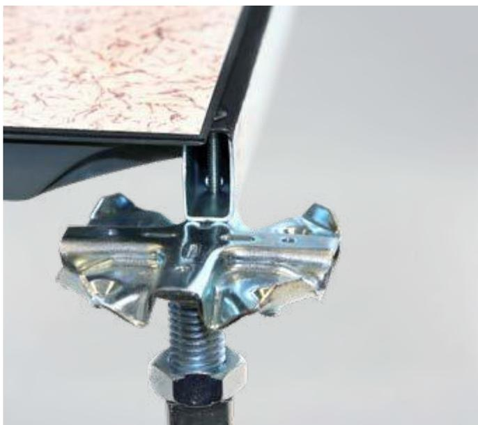
Placa de acero superior lisa de 0,7 mm de espesor, soldada a una placa de acero inferior de 0,9 mm de espesor estampada, embutida con relleno de concreto celular leve y apoyada en pedestales metálicos de altura ajustable. Del lado inferior los domus se encuentran ubicados de forma aleatoria para garantizar resistencia y evitar líneas de ruptura. La placa recibe protección en pintura epoxi.
