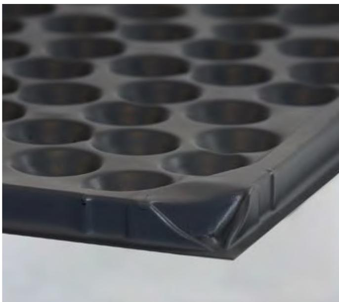
Placa de acero superior lisa de 0,6 mm de espesor soldada a una placa de acero inferior estampada (domus) de 0,7 mm de espesor, embutida con relleno de concreto celular leve y apoyada en pedestales metálicos de altura ajustable. Del lado inferior los domus se encuentran ubicados de forma aleatoria para garantizar resistencia y evitar líneas de ruptura. La placa recibe protección en pintura epoxi.
