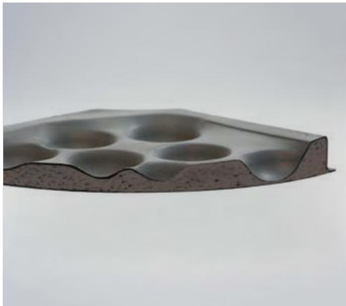
Placa de acero superior lisa de 0,7 mm de espesor, soldada a una placa de acero inferior estampada (domus) de 1,2 mm de espesor, embutida con relleno de concreto celular leve y apoyada en pedestales metálicos de altura ajustable. Del lado inferior los domus se encuentran ubicados de forma aleatoria para garantizar resistencia y evitar líneas de ruptura. La placa recibe protección en pintura epoxi.
