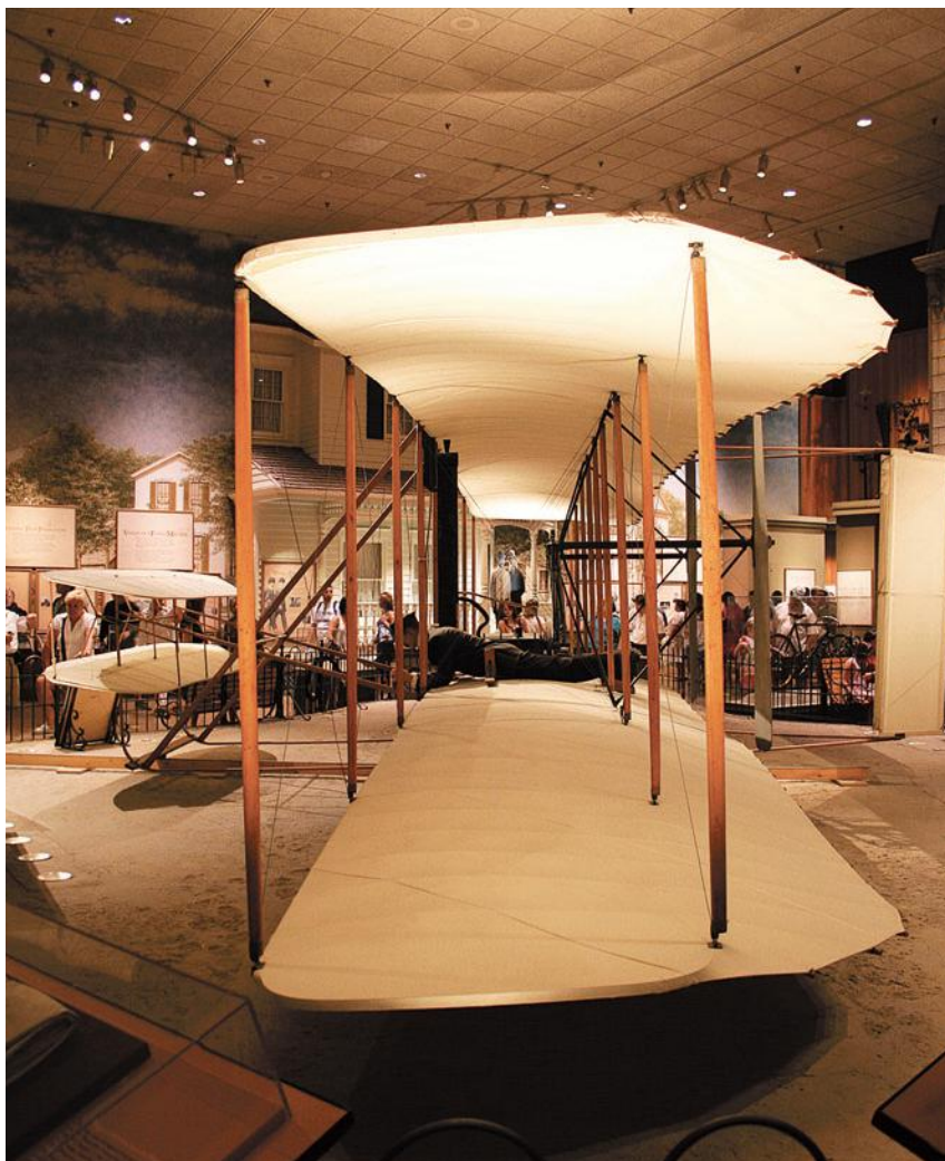
Wright anaien Flyer hegazkinaren kopia bat. Garai hartako hegazkinen hegoak bi aldeetatik ziren kurbatuak, goitik eta behetik. Beraz, Bernoulliren efektua baztergarria zen hego haietan, eta, hala ere, hegan egiten zuten. ARG: 350Z33/CC-BY-SA.
