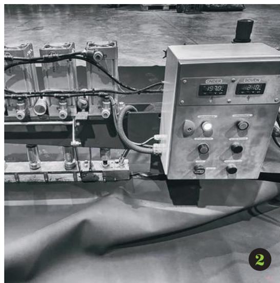
La membrane sera assemblée par soudures à chaud sur base du plan de fabrication.
