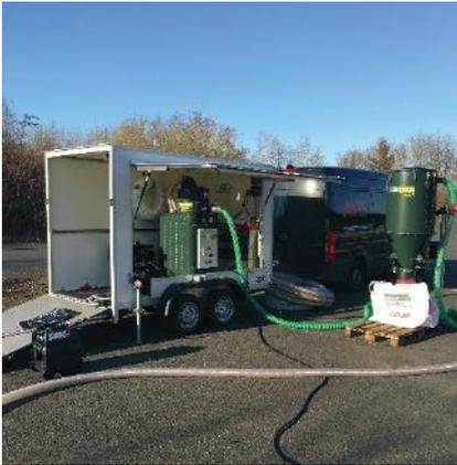
Absaugung des Fräsguts nach außen
