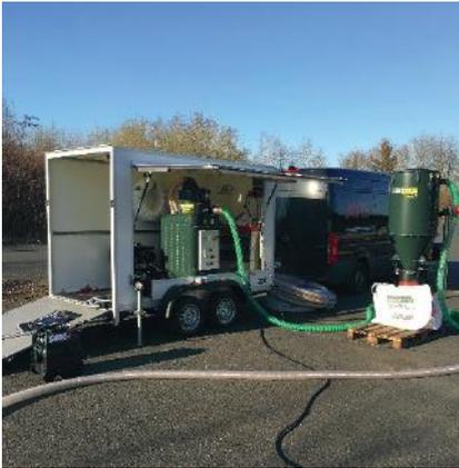
Absaugung des Fräsguts nach außen
