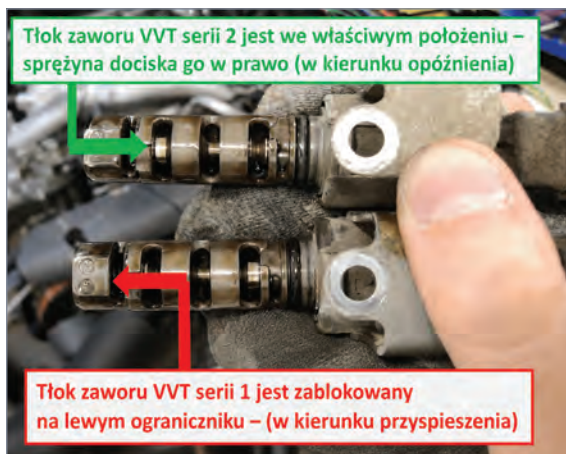
Ilustracja 8. Porównanie położenia tłoka zaworu sterującego VVT.
