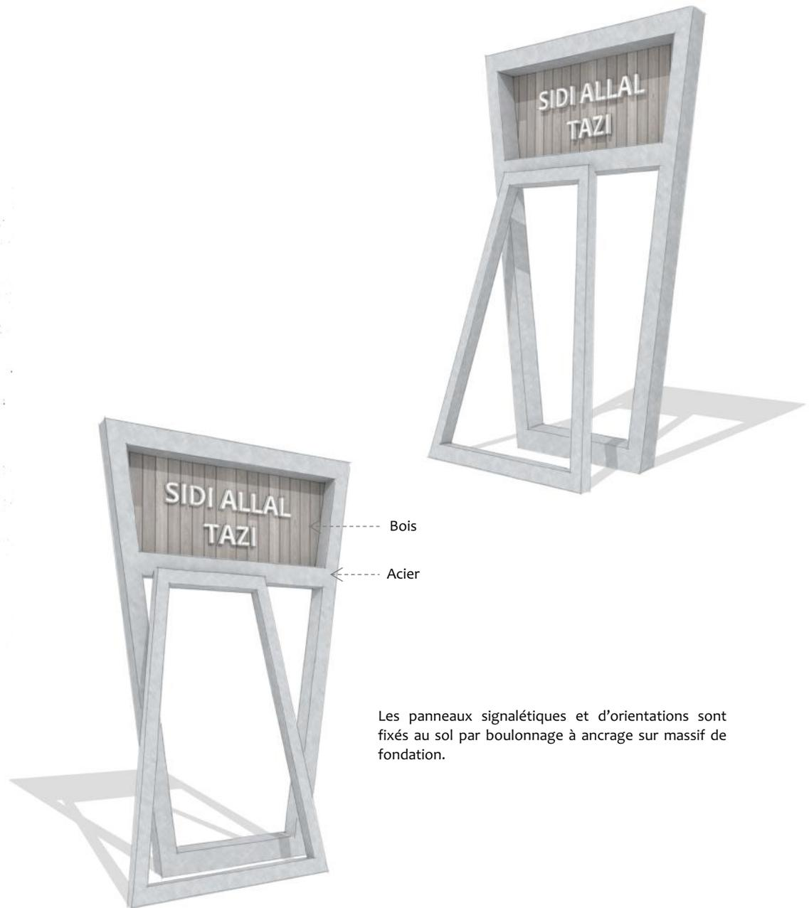
Les panneaux signalétiques et d'orientations sont fixés au sol par boulonnage à ancrage sur massif de fondation.
