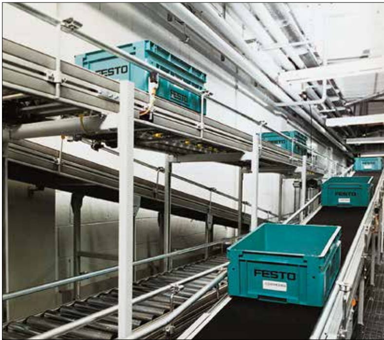
Eurotec-Behälter sind perfekt für Förderbänder und Rollenbahnen.
