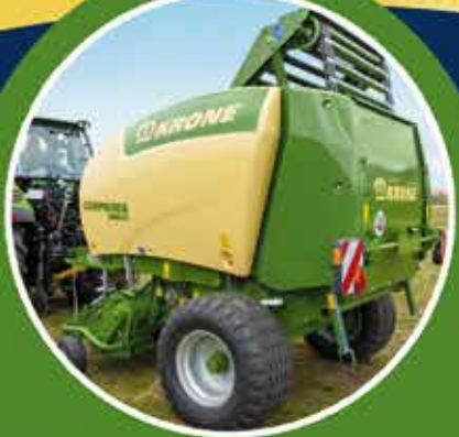
Enfardadora modelo Comprima F155 XC SISTEMA DE BARRA Fardo de 1,20 a 1,55 mts. MONO EJE Y TANDEM.
