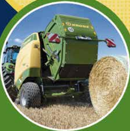
Enfardadora modelo Varipack 165 / 190. CORREA Dos modelos: Fardo de 0,90 a 1,65 mts y 0,90 a 1,90 mts
