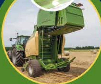
Enfardadora modelo Comprima Cámara Variable V150 XC / V180 XC SISTEMA DE BARRA Dos modelos: Fardo de 0,90 a 1,65 mts y 0,90 a 1,80 mts. MONO EJE Y TANDEM.
