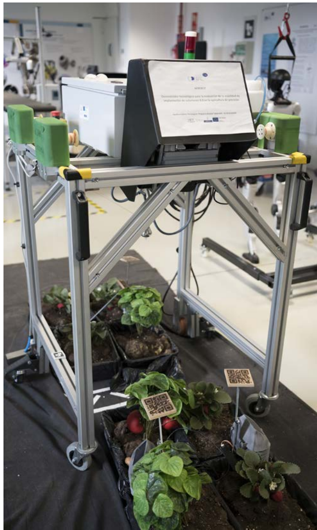
Prototipo resultado del Programa Asturias de 2020, que pasa por el campo y revisa las características y problemas de las plantas, como falta de agua o aparición de plagas.
