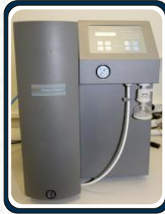
Şehir şebekesi beslemeli ASTM Tip 1 (UP), ASTM Tip 3 (RO) ve Bi-Distile tiplerde saf su üretebilen su saflaştırma & distilasyon sistemleri
