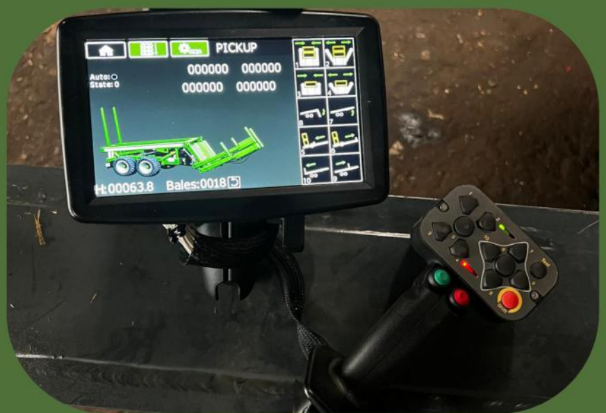
7" skærm med joystick, til nem styring af Bale Convoy
