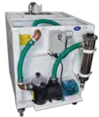
Die Entleerung des Absetzbeckens startet bei Erreichen der Maximal-Befüllung automatisch und stoppt bei Erreichen der Minimal-Befüllung (gesteuert durch Schwimmerschalter).
