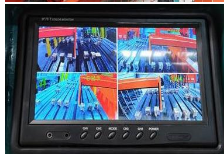
Cámaras y monitor para garza.
