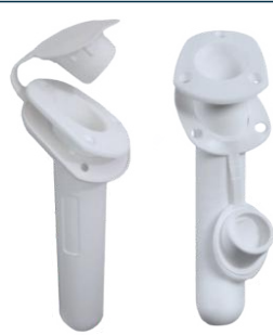
2170 Porta caniço com tampa PVC branco, inclinação 30°, fixado por parafusos. Ideal para a instalação no costado de barcos, lanchas e veleiros. Dimensões: 249 x Ø83 mm
