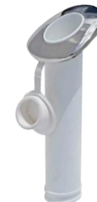
0831-1594 Porta caniço PVC acabamento inox Em nylon branco, acabamento em aço inox, tampa de borracha, inclinação de 30°, fixado por parafusos, abertura de 44 mm. Dimensões: 278 x Ø46 mm
