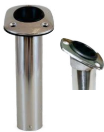
0141 Porta caniço fundido Aço inox, acabamento interno em PVC, inclinação 30°. Ideal para a instalação no costado de barcos, lanchas e veleiros. Dimensões: 233 x Ø41 mm
