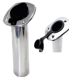
0103 Porta caniço com tampa Aço inox, acabamento interno em PVC, com tampa em borracha, inclinação 30°. Ideal para a instalação no costado de barcos, lanchas e veleiros. Dimensões: 233 x Ø41 mm
