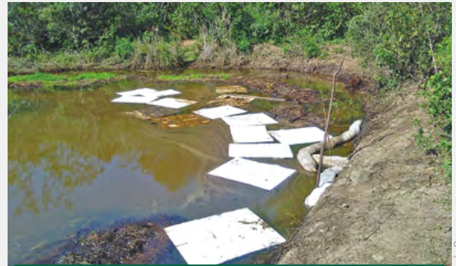
Uso de mantas para adsorção de óleo é uma opção de controle
