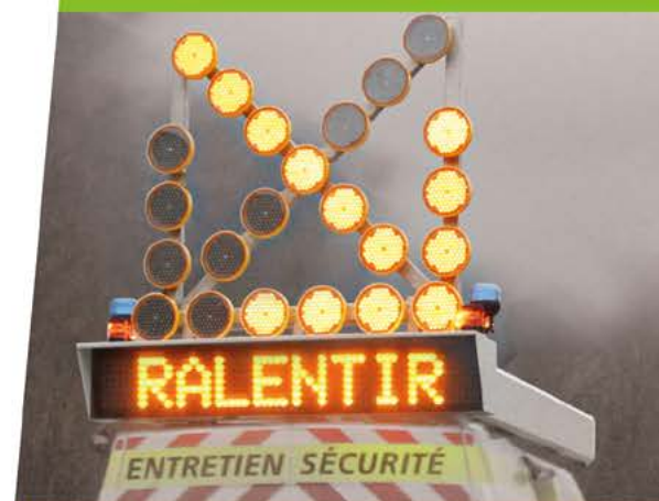
FLÈCHE LUMINEUSE D'URGENCE - FLU P 47
