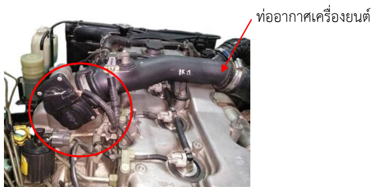
รูปที่ 6.7 ตัวตรวจจับและส่งสัญญาณตำแหน่งลิ้นเร่งและตำแหน่งติดตั้ง
