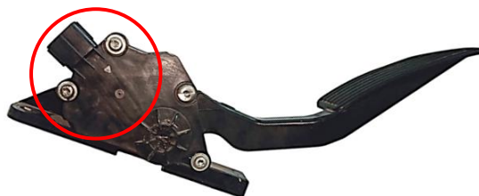
รูปที่ 6.18 ตัวตรวจจับและส่งสัญญาณตำแหน่งขาคันเร่ง ที่มา : นายจิรโรจน์ เลิศธนเปี่ยมสุข. 2565
