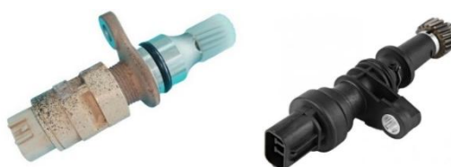
รูปที่ 6.16 ตัวตรวจจับและส่งสัญญาณความเร็วรถยนต์
