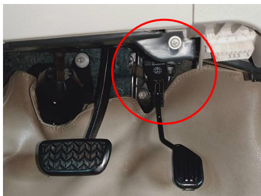
รูปที่ 6.19 ตำแหน่งติดตั้งตัวตรวจจับและส่งสัญญาณตำแหน่งขาคันเร่ง ที่มา : นายจิรโรจน์ เลิศธนเปี่ยมสุข. 2565
