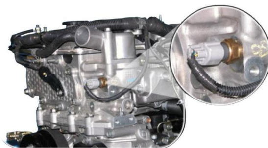
รูปที่ 6.2 ตำแหน่งติดตั้งตัวตรวจจับและส่งสัญญาณอุณหภูมิน้ำหล่อเย็น ที่มา : นายจิรโรจน์ เลิศธนเปี่ยมสุข. 2565
