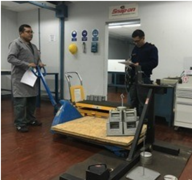
Calibración de Torque Tester TTC-2000
