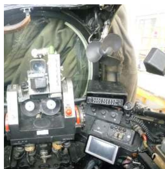
Modificación de la cabina del Artillero del Mi-25
