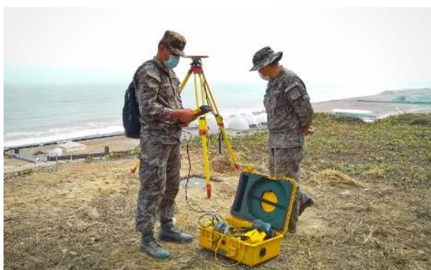
Figura 3. Establecimiento del punto de control terrestre horizontal
