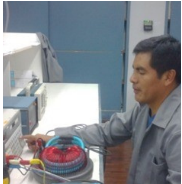
Calibración de Pinza Amperimétrica
