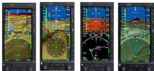
Visualización de diferentes instrumentos configurables en la pantalla ASPEN 1000 PFD (PRIMARY FLIGHT DISPLAY)
