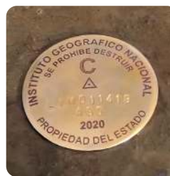
Figura 7. Punto de control terrestres horizontal - vertical N°3
