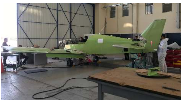
Proceso de ensamblaje de la aeronave CH2000
