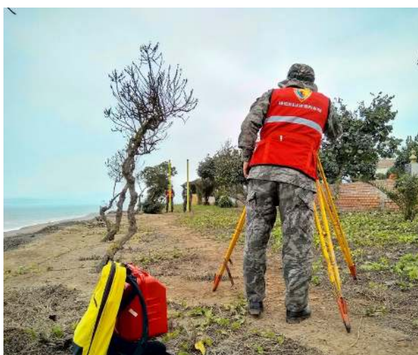
Figura 4. Establecimiento del punto de control terrestre vertical
