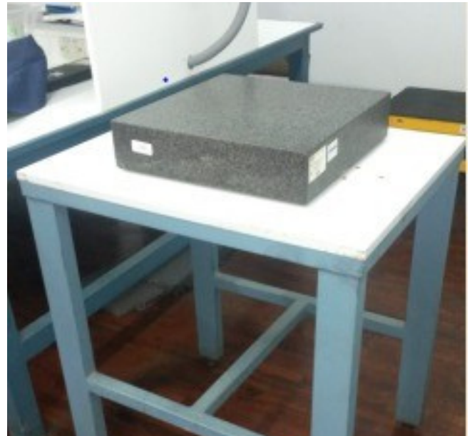
Mesa de planitud para calibrar pie de rey, reloj comparador y micrómetros
