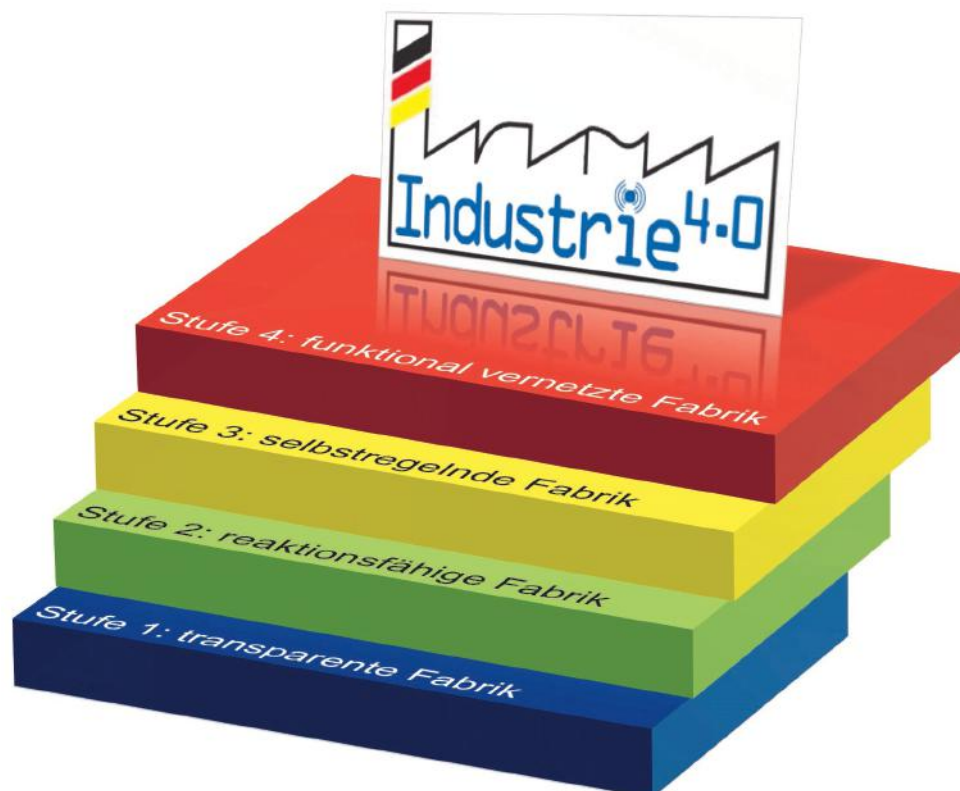
Bild 2: Vier-Stufen-Modell „Smart Factory“
