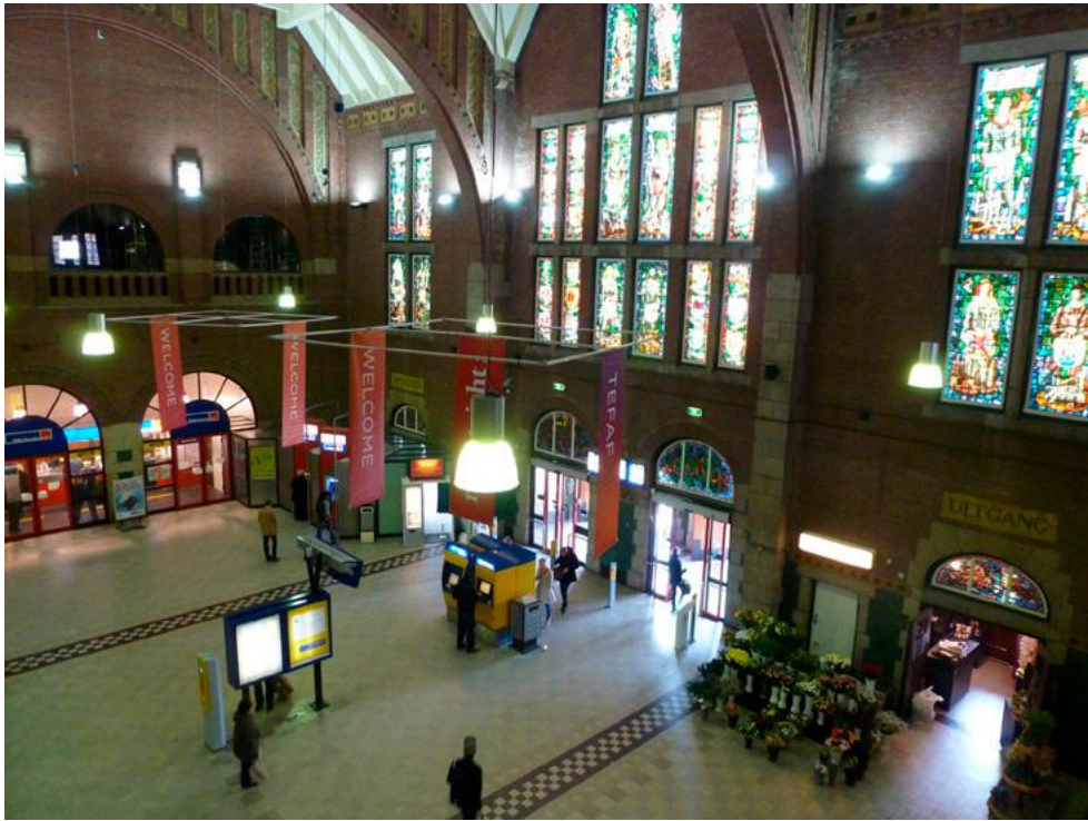
Vestibule. In de bogen, langs de bovenzijde van de wanden, boven deuropeningen etcetera zijn decoraties aangebracht van tegels en terracotta. De muren bestaan uit baksteen, deels groen verglaasd, en graniet. Verder zijn hier diverse decoraties in glas en lood te zien, bijvoorbeeld boven de uitgang (thans bloemenwinkel).
