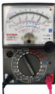
(ก) สายสีแดงแตะขา D สายสีดำแตะขา S
