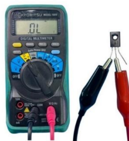
รูปที่ 4.53 การวัดระหว่างขา A กับขา K ของเอสซีอาร์
