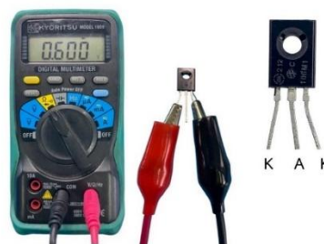
รูปที่ 4.52 การวัดระหว่างขา G กับขา K ของเอสซีอาร์
