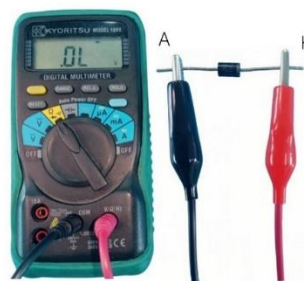
รูปที่ 4.45 การวัดและทดสอบไดโอดด้วยการไบอัสกลับ
