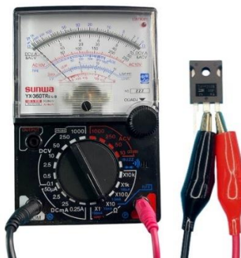
(ข) สายสีดำแตะขา G สายสีแดงแตะขา S
