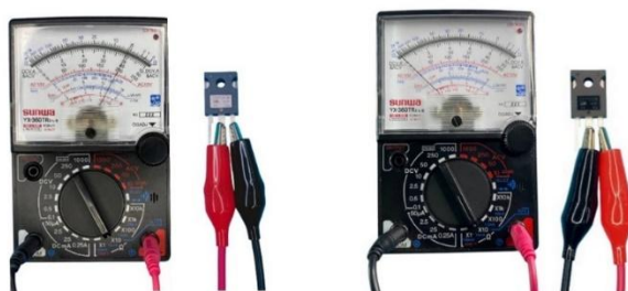
(ก) โพรบสีแดงแตะขา D โพรบสีดำแตะขา S (ข) โพรบสีดำแตะขา G โพรบสีแดงแตะขา S
