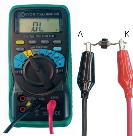
รูปที่ 4.47 การวัดและตรวจสอบซีเนอร์ไดโอด กรณีมีแรงดันน้อยกว่าแรงดันมัลติมิเตอร์ดิจิทัล
