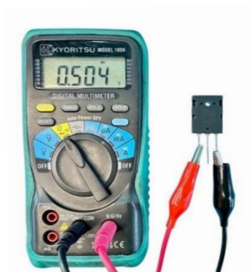
รูปที่ 4.48 การวัดและทดสอบทรานซิสเตอร์ ชนิด NPN ด้วยมัลติมิเตอร์ดิจิทัล ที่มา : จิรโรจน์ เลิศธนเปี่ยมสุข. 2565
