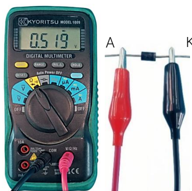
รูปที่ 4.44 การไบอัสตรงให้กับไดโอด
