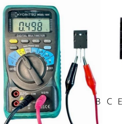
รูปที่ 4.49 การวัดและทดสอบทรานซิสเตอร์ ชนิด PNP ด้วยมัลติมิเตอร์ดิจิทัล ที่มา : จิรโรจน์ เลิศธนเปี่ยมสุข. 2565
