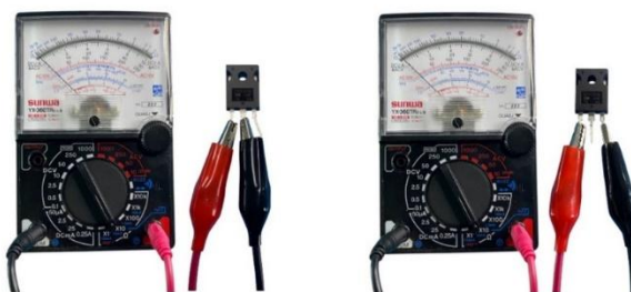
(ค) โพรบสีแดงแตะขา G โพรบสีดำแตะขา D (ง) โพรบสีดำแตะขา D โพรบสีแดงแตะขา S
