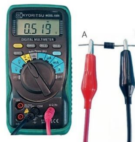
รูปที่ 4.44 การวัดและทดสอบไดโอดด้วยการไบอัสตรง
