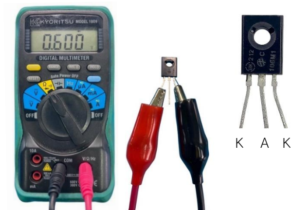
รูปที่ 4.52 การวัดระหว่างขา G กับขา K ของเอสซีอาร์
