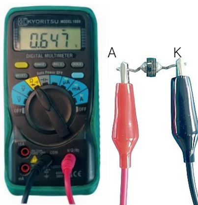
รูปที่ 4.46 การวัดและตรวจสอบซีเนอร์ไดโอด กรณีมีแรงดันมากกว่าแรงดันมัลติมิเตอร์ดิจิทัล
