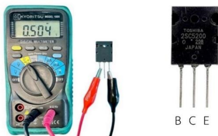
รูปที่ 4.48 การวัดและทดสอบทรานซิสเตอร์ ชนิด NPN ด้วยมัลติมิเตอร์ดิจิทัล
