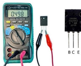
รูปที่ 4.49 การวัดและทดสอบทรานซิสเตอร์ ชนิด PNP ด้วยมัลติมิเตอร์ดิจิทัล
