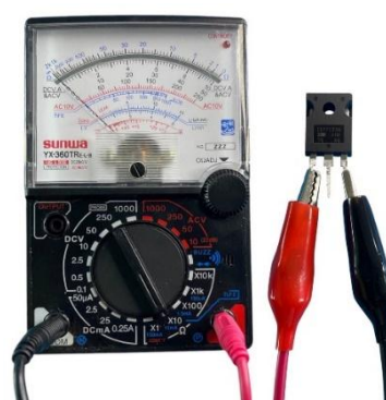
(ง) สายสีดำแตะขา D สายสีแดงแตะขา S
