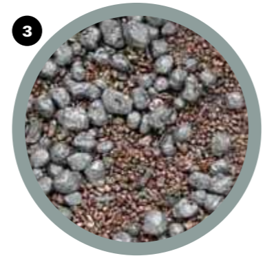
3 Misto metalli. Pezzatura fino a 20 mm. Mixed metals. Pieces up to 20 mm size. Métaux mélangés. Dimension jusqu'à 20 mm. Metales mixtos. Tamaño hasta 20 mm. Gemischte Metalle. Korngröße bis 20 mm.
