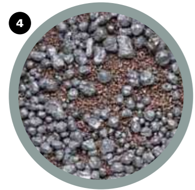
4 Misto metalli. Pezzatura fino a 10 mm. Mixed metals. Pieces up to 10 mm size. Métaux mélangés. Dimension jusqu'à 10 mm. Metales mixtos. Tamaño hasta 10 mm. Gemischte Metalle. Korngröße bis 10 mm.
