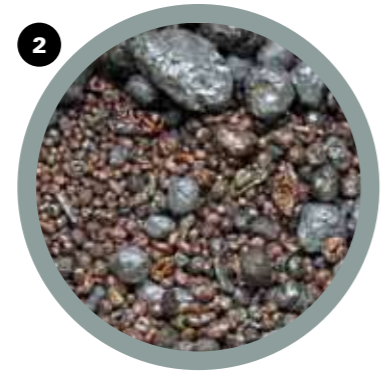
2 Misto metalli. Pezzatura fino a 35 mm. Mixed metals. Pieces up to 35 mm size. Métaux mélangés. Dimension jusqu'à 35 mm. Metales mixtos. Tamaño hasta 35 mm. Gemischte Metalle. Korngröße bis 35 mm.
