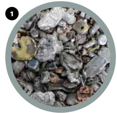
1 Misto metalli. Pezzatura fino a 50 mm. Mixed metals. Pieces up to 50 mm size. Métaux mélangés. Dimension jusqu'à 50 mm. Metales mixtos. Tamaño hasta 50 mm. Gemischte Metalle. Korngröße bis 50 mm.
