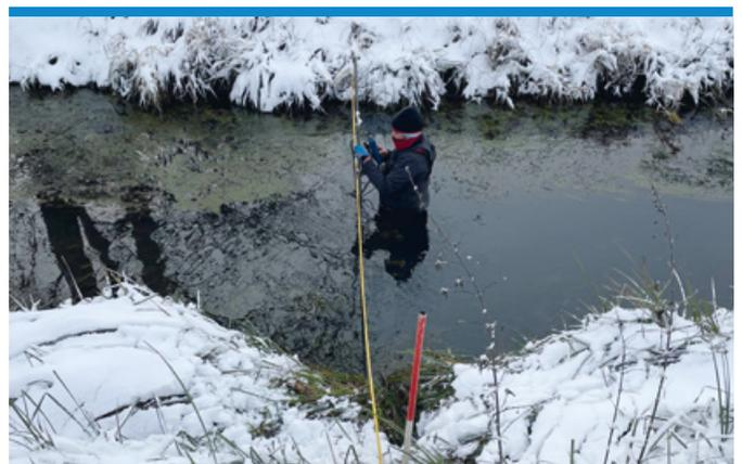
Abflussmessung mit Strömungsmessgerät in Gewässer bei winterlichen Bedingungen
