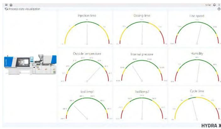
供应链互联IT系统的生动例子是将BALLUF Mold-ID连接到HYDRA资源管理应用。如果由分包商使用，可监控注模工具。系统监控指定的维保间隔是否符合并保存工具使用。通过工具RFID芯片上的Mold-ID完成相关数据的本地采集。工具返回时，数据传送到MES并集中可用。这将弥补两家公司间的信息差。通过将工具数据关联到分供应商产品批次相关信息，本地采集的数据也可以用于跟踪追溯。
