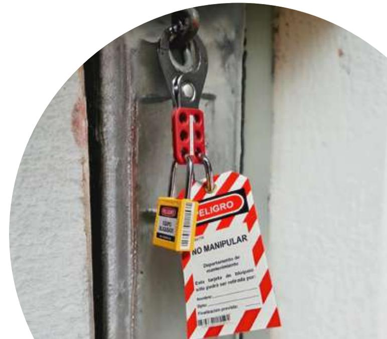
Herramientas utilizadas para asegurar dispositivos de bloqueo en interruptores u otros mecanismos, evitando activaciones no autorizadas.
